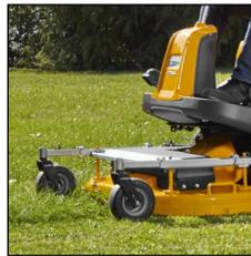
112 cm Frontmäherwerk und 3-in-1 Mähfunktion: Fangen, Mulchen, Heckauswurf.
